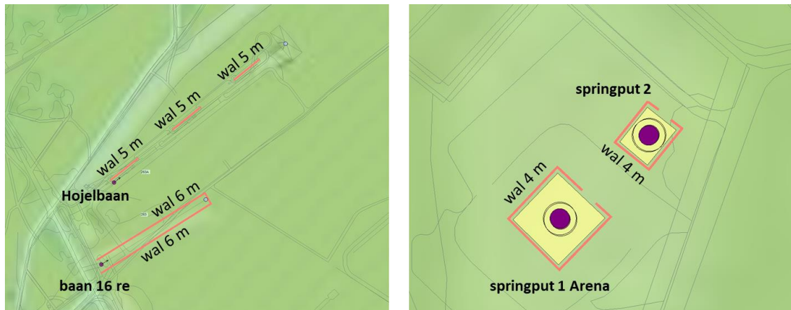
Figuur B3 Links: wallen bij de Hojelbaan en baan 16 rechts. Rechts: wallen bij springput 1 en springput 2 Arena. (De zandbodem binnen de wallen ligt 4 meter beneden het omliggende maaiveld.)
